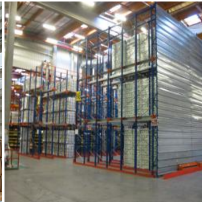
Rayonnage à accumulation / Drive in
